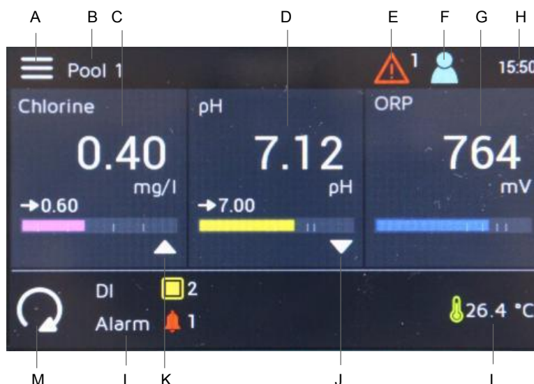
Bilde 1 Hovedmeny som viser en feilmelding (for eksempel klor, pH og ORP-måling)
