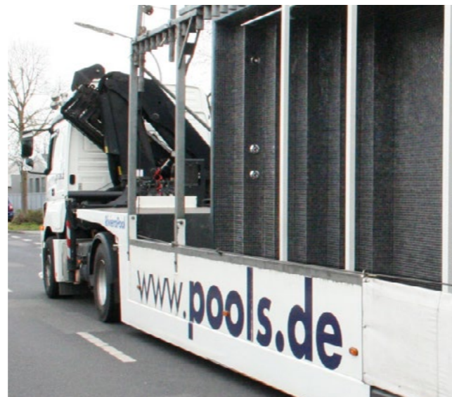
Die Konstruktion wird im Werk und nicht auf der Baustelle gefertigt. Unser Spezialtransporter bringt Ihren Pool hochkant bzw. im Breittransport gelagert an die Baustelle. Auch mehrteilige Becken sind möglich - Fügstellen werden dann vor Ort mit Mosaik überarbeitet.
