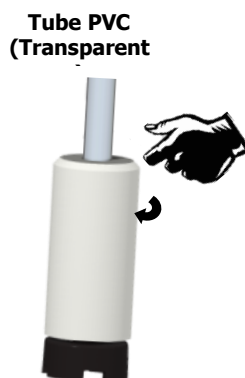
Etape 16 Serrer l'écrou sur le cône.
