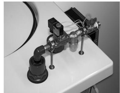
Niveau- und Pumpensteuerung, mit Magnetventil
