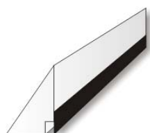
Ferdig prefabrikkert hulkile
